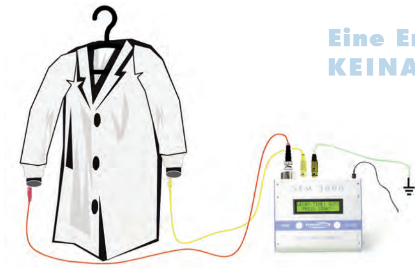
Anordnung zur Messung des Ladungsabbauverhaltens (DECAY) von EPA-tauglicher Arbeitskleidung
