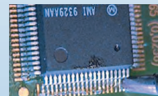
4. Bauteil an 1 Lead fixieren, Position überprüfen, danach diagonal an 2. Lead fixieren.
