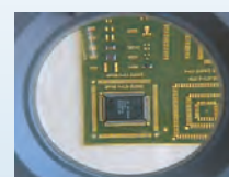
2. Bauteil unter Lupe ausrichten
