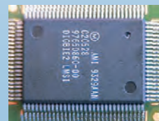
6. Fertig - mit gleichmäßig ausgeformten Lötstellen
