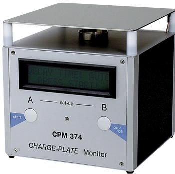
Der CPM 374 eignet sich durch seine kompakte Bauweise und durch den Akku-Betrieb hervorragend für den mobilen Einsatz, zur Akkuschonung wird dabei auf die Hintergrundbeleuchtung des Displays verzichtet. Abschaltung erfolgt automatisch nach Messende, wenn innerhalb 10 min kein Taster betätigt wurde.
