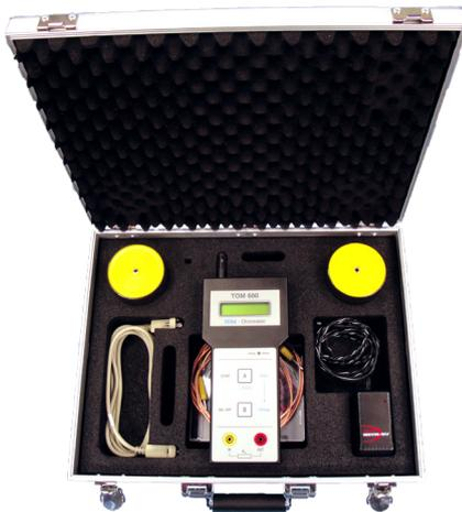
Das TOM TF 600 arbeitet nach dem Stromspannungsmessverfahren. Zur Durchführung der Messungen nach festgelegten Normen IEC DIN EN 61340 kann die in der Norm vorgeschriebene Messzeit über den internen Timer eingestellt werden. Die Messwerte werden im internen EEPROM gespeichert und können zu einem späteren Zeitpunkt über die PC-Schnittstelle ausgelesen werden.
